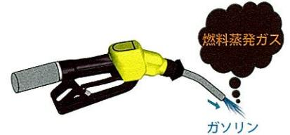
燃料蒸発ガスは回収されずに車両給油口周辺より、空气中に放出されていました。
